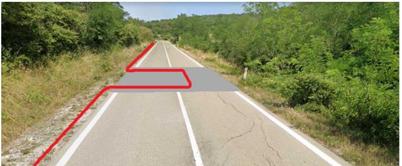
Foto 9 simulata: l'immagine mostra un tratto del termodotto interrato (tratto rosso) posto sul lato di monte, come indicazione tipica viene mostrato un "loop" che attraversa una carreggiata della strada provinciale SP160. NOTA: per chiarezza il percorso della tubazione è riportato in evidenza ma la realizzazione finale prevede ovunque il completo interramento con ripristino della configurazione originale del sedime.
